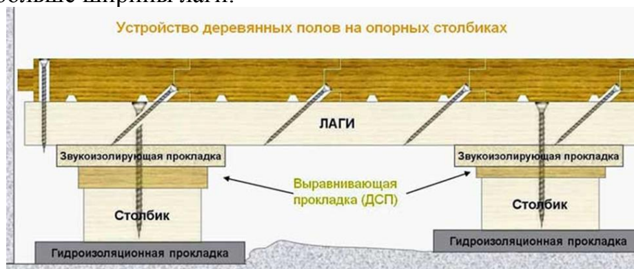
Рисунок 28 - Устройство деревянных полов на опорных столбах
