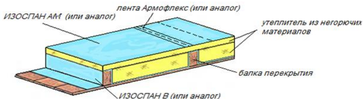
Рисунок 24 - Утепление деревянного перекрытия
