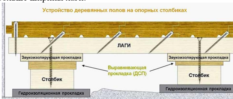
Рисунок 29 - Устройство деревянных полов на опорных столбах
