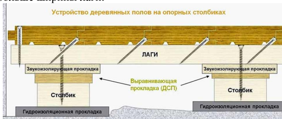
Рис. 27 Устройство деревянных полов на опорных столбах
